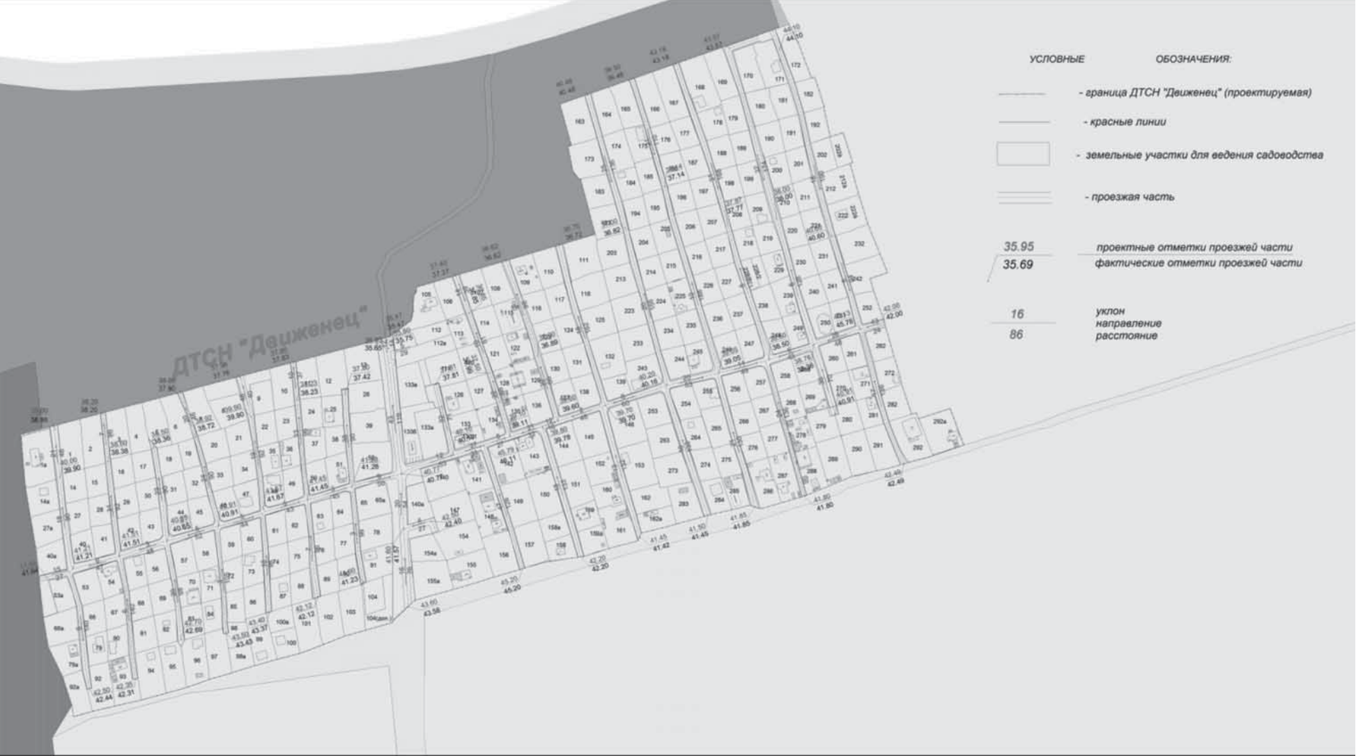
Схема вертикальной планировки и инженерной подготовки территории
